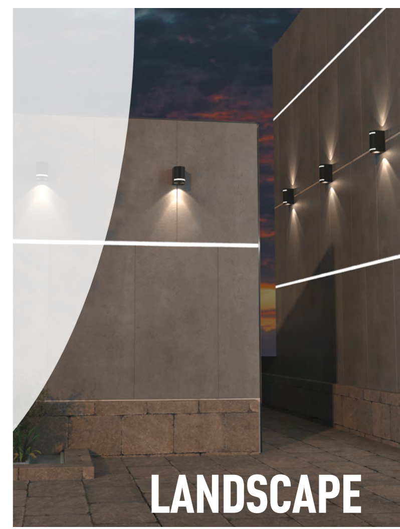
IP 54 Светильник ландшафтный светодиодный Корпус – алюминий/ рассеиватель – закаленное стекло GU10 max 2*15 Вт LED 220 В Диапазон раб. тем-р от -20° до +50° С
