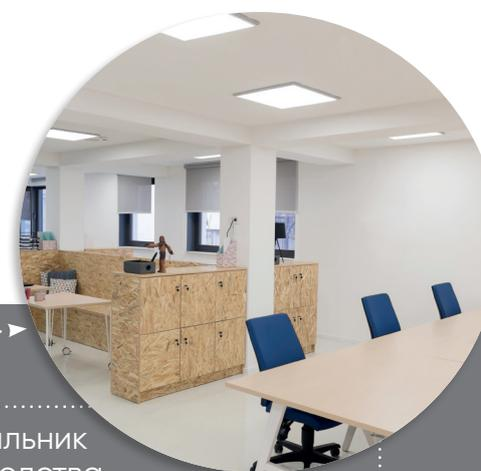
Светодиодный светильник российского производства Feron серии TR Армстронг используются для основного освещения коммерческих помещений, офисов, магазинов и тп. Драйвер расположен вне зоны видимости. Рассеиватель из полистирола не желтеет и не изменяет формы в процессе эксплуатации, создает наиболее комфортный для зрения световой поток, а отсутствие пульсаций освещенности обеспечивает полную безопасность для зрения.
