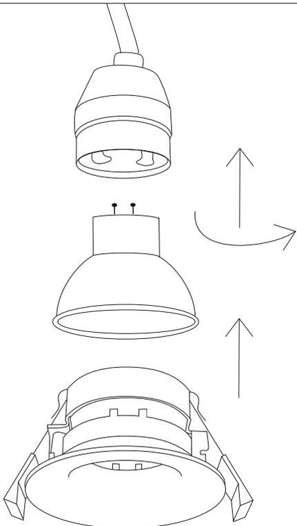
3. Установите лампу Gu10 в патрон и закрепите их в светильнике при помощи пружин.
