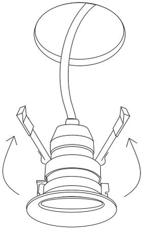
4. Отогните пружинные ушки светильника вверх и установите светильник в монтажное отверстие.
