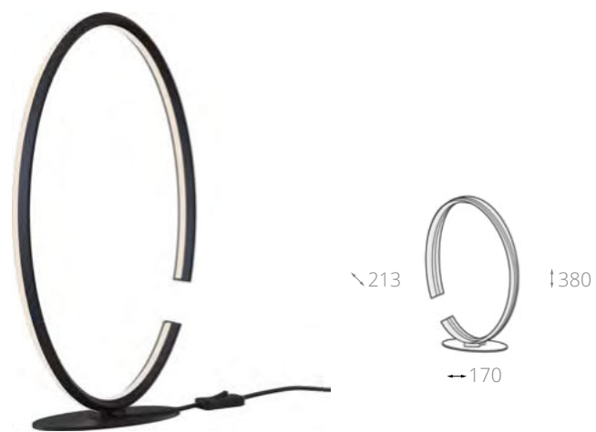
▲ MOD036TL-L23B LED 23W 1000 lm, 3000 K, >80 Ra, 120 ° 220-240 V, IP20 380 × 213 × 170 мм
