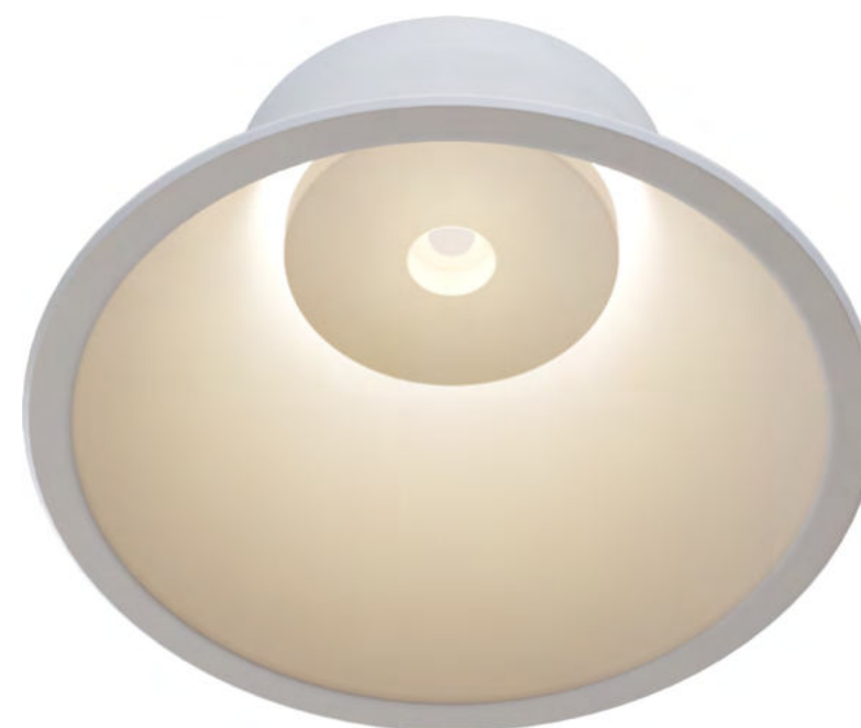
◀ DL039-L15W4K LED 14W 850 lm, 4000 K, >80 Ra, 120 ° 100-240 V, IP20 Ø 150 × 85 мм DL039-L15W3K LED 14W 750 lm, 3000 K, >80 Ra, 120 ° 100-240 V, IP20 Ø 150 × 85 мм
