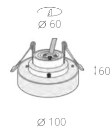
▲ DL035-2-L6W LED 11W 750 lm, 3000 K, >80 Ra, 36 ° 100-240 V, IP20 Ø 100 × 60 мм
